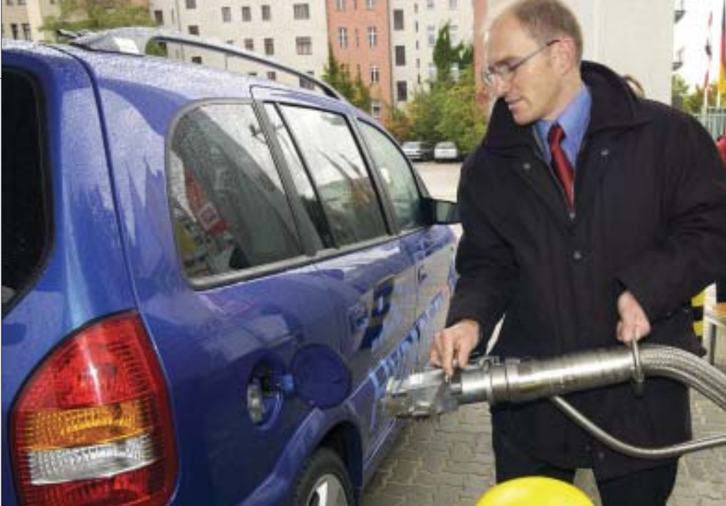
▲ Noch auf Jahre hinaus selten zu sehen: Betanken eines Brennstoffzellenautos mit Wasserstoff.
